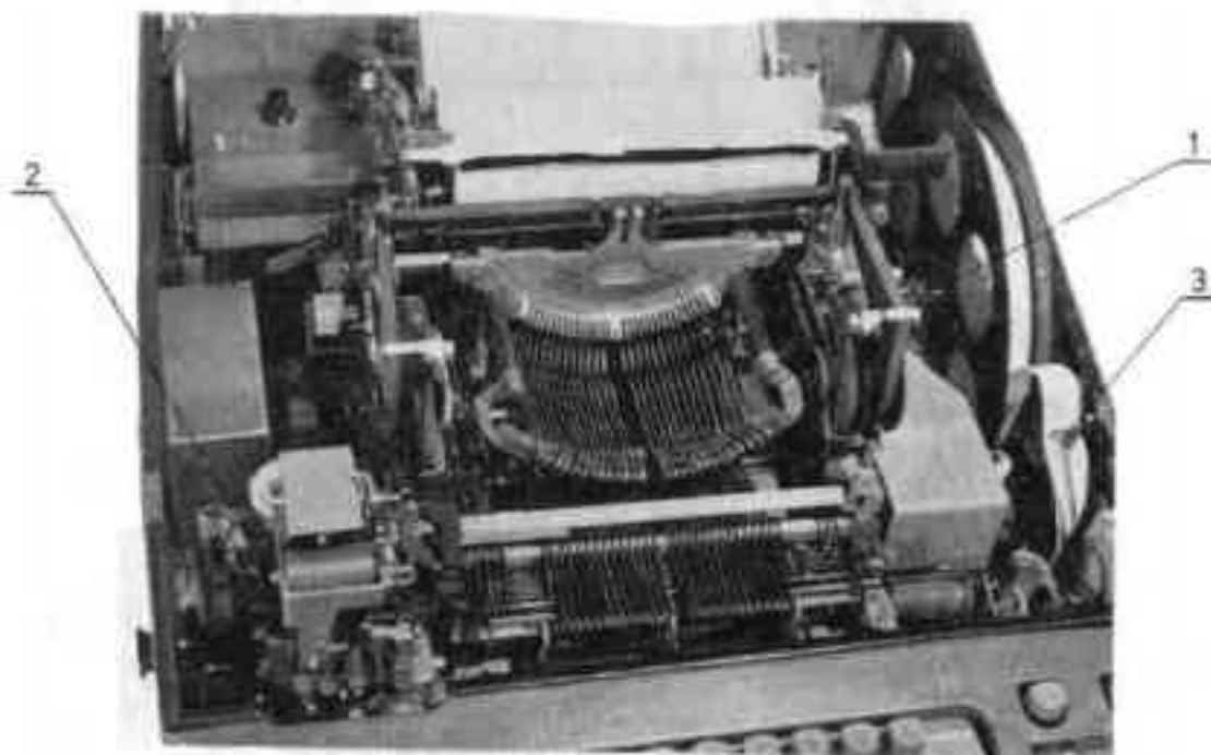
Sl. 31. - Postavljanje papirne trake širine 17,3 mm
